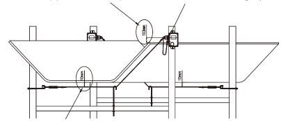
벨트 바닥과 와이어간 거리는 10mm를 유지 하시오 Keep 10mm distance between belt bottom and wire
